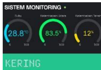
Gambar 11. Interface Tampilan Kelembapan Tanah >60%
