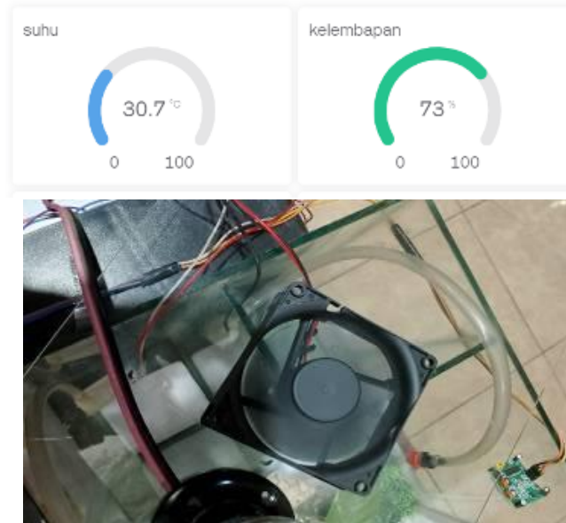
Gambar 4. Kipas DC Menyala pada Suhu >30^{\circ}\text{C}
