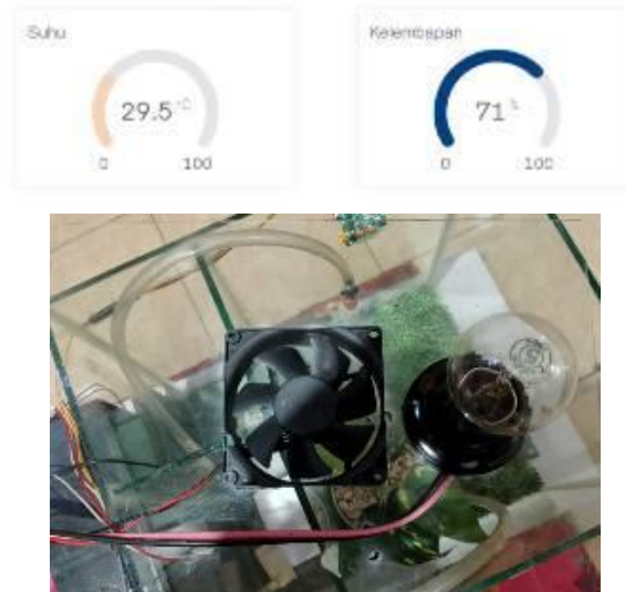
Gambar 6. Lampu dan Kipas DC mati pada suhu <27^{\circ}\text{C} - >30^{\circ}\text{C}
